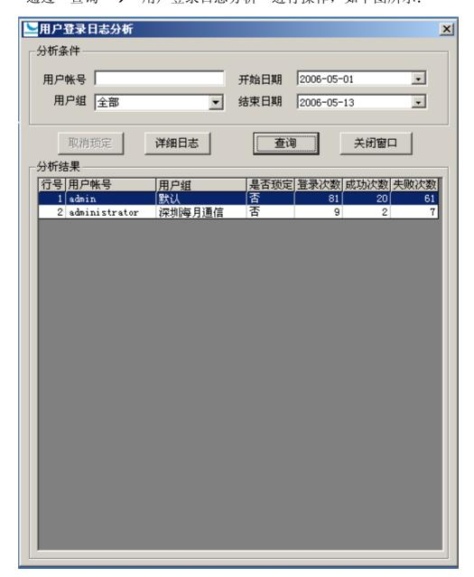
对于已经被锁定的用户,系统管理员可以取消锁定,方法:先选择被锁定的用户,然后点击"取消锁定"即可。
